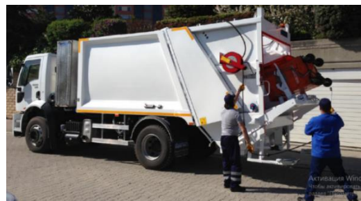
Фото. Сміттевоз HIDRO MAK з функцією миття та дезінфекції контейнерів
